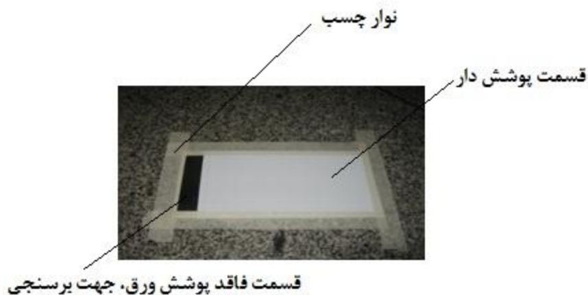
شکل ۴- تصویری از روش ثابت نمودن ورق جهت اندازه گیری ضخامت
